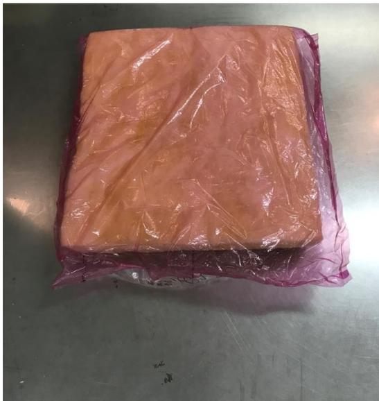
写真 2-1 気流止め用の部材
