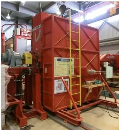
写真 2-3 水密気密試験装置外観
