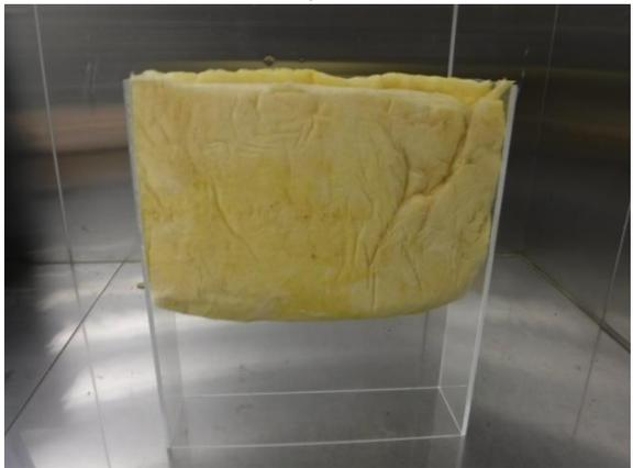
写真 2-21 挿入幅が壁幅に対して大きい
