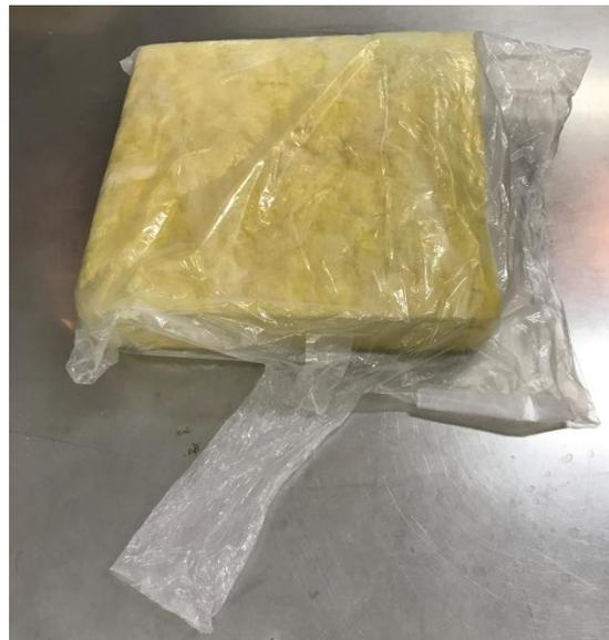
写真 2-2 減圧圧縮した気流止め専用部材
