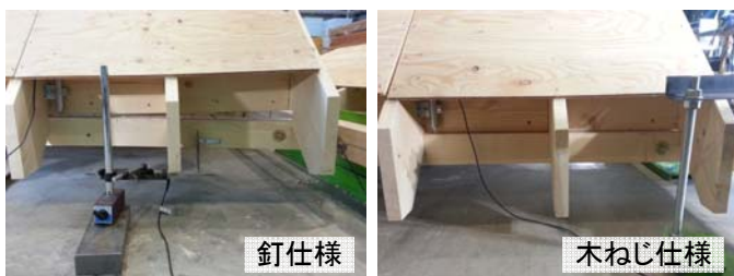
図4 変形状・破壊形態の確認
