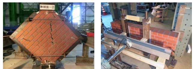
(a) れんが壁のせん断試験 (b) れんが壁の曲げ試験 写真2 構造実験の一例
