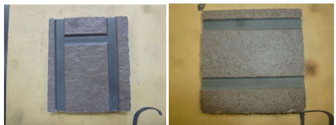
写真 木繊維補強セメント板(左：暴露前、右：暴露後)
