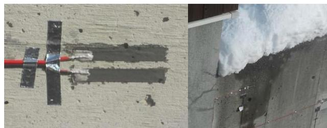
図3 コンクリート表面の濡れ測定
