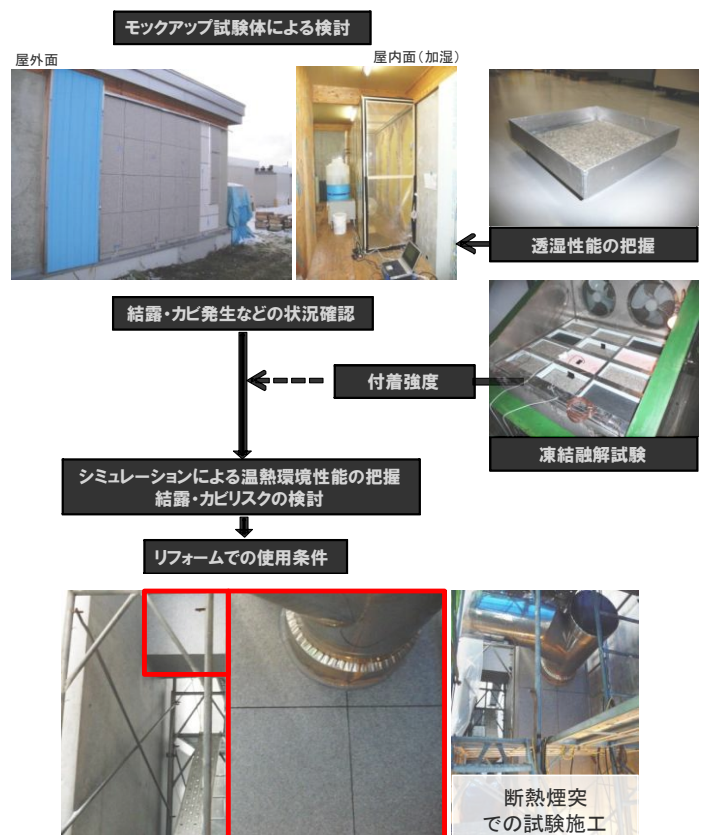
図1：研究の流れおよび実験・暴露試験体、試験施工の様子
