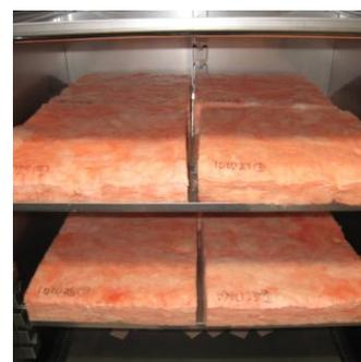
写真3 加速劣化試験状況
