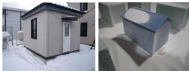
(a) 積雪状況の観測 (b) 吹雪風洞実験
