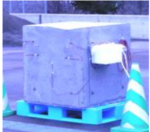
写真1 内部の温湿度分布を測定中の試験体
