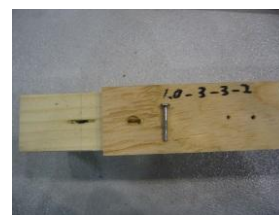
☞釘の破断 （釘頭から平均19.4mmの位置で破断。）
