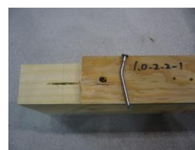
☞釘の曲げを伴うせり出し （釘頭から平均2.7mmの位置に塑性ヒンジ発生）
