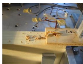
☞構造用合板(9mm規格)の破断
