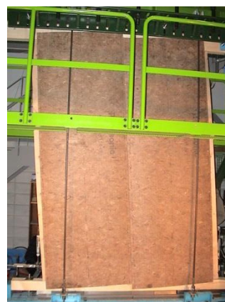
▲実大壁体による構造性能確認実験
