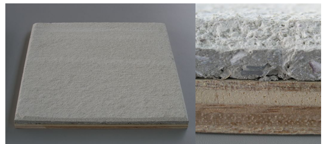
事例③ ホタテ貝殻を骨材に用いたモルタルの開発
