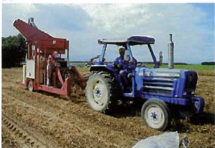
ビーンハーベスタで刈り倒されたアズキを、ピックアップスレッシャーで収穫中。更別村（竹中原図）。'01. 09.
