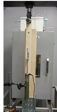
▲外張断熱壁における外装材下地支持力の試験方法の一例
