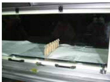
写真 1 吹雪風洞実験による検討
