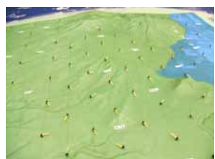
写真 2 風洞実験による検討 (タフト法による風向解析)
