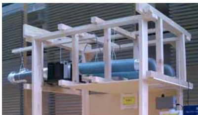
室内粉じんによる風量低下測定機器
