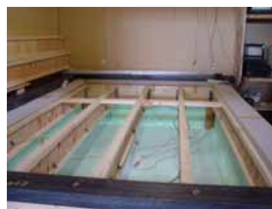
実大模型による放熱量測定
