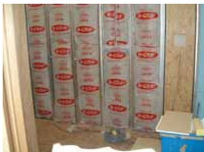
放湿試験体に断熱材を充填し、冬期の防露性能を検証
