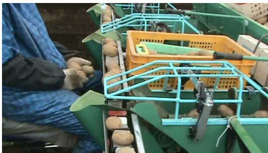
写真2 補充業者は、プラント後部に取り付けられた補充コンベヤに種いもを補充する
