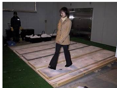
斜路での歩行試験試験
