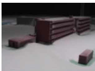
写真 6 住棟周囲の吹きだまり
