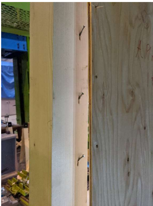
(a) 釘の頭抜け破壊
