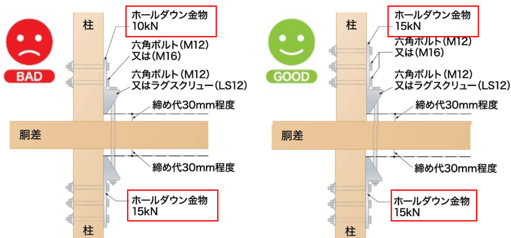
図 4-10 ホールダウン金物選定の考え方
