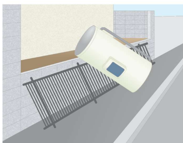
図 7-1 温水機器・貯湯タンクの転倒被害イメージ
