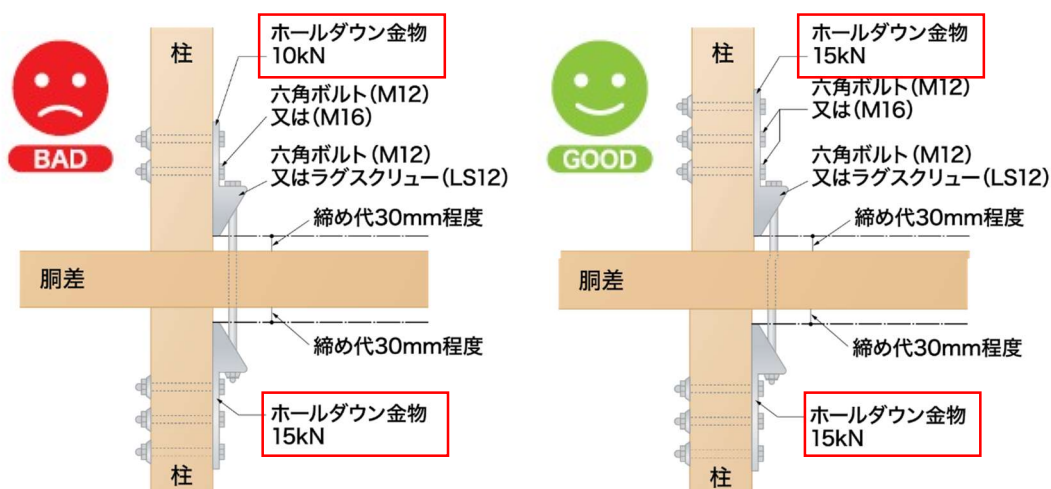
図 4-10 ホールダウン金物選定の考え方
