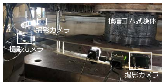
図2 積層ゴムの多視点同時撮影手法
