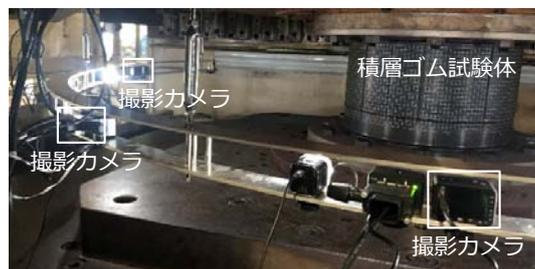
図2 積層ゴムの多視点同時撮影手法
