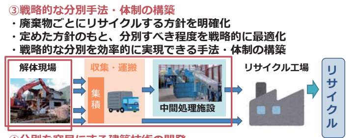
図4 システムの提言② 解体現場への対応
