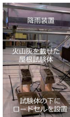
写真1 降灰後の降雨 図2 積灰荷重および含水率の推移を模擬したモデル実験 (屋根勾配2/10の場合)
