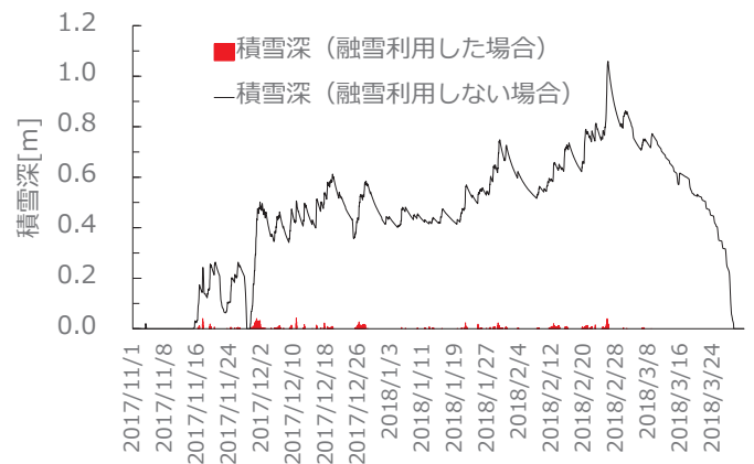
図4 排熱を利用した融雪のシミュレーション結果 (美唄市、融雪面積 3m^2 、アスファルト路面の場合)
