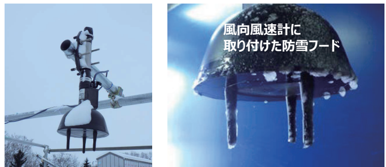
写真1 積雪による欠測を軽減し融雪電力を削減する防雪フードを用いた新たな設置方法
