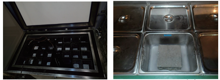
図2 促進試験方法 JISA1148A法 RILEM CIF試験
