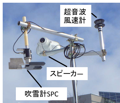
図4 機材設置状況
