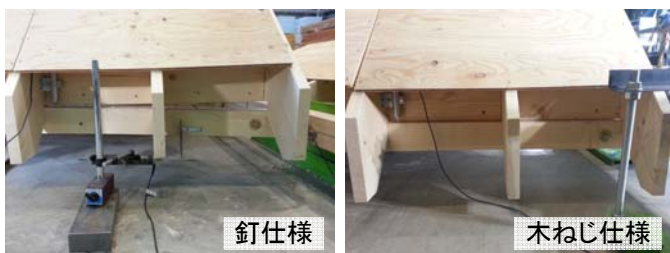
図4 変形性状・破壊形態の確認
