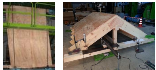
写真1 道産材を用いた構造部材の性能確認
