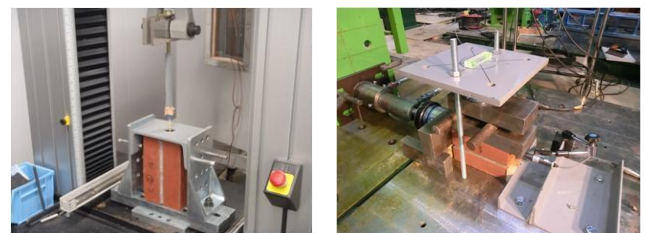
(a)れんが目地と補強材の付着試験 (b)れんが目地のせん断試験 写真1 要素試験の一例
