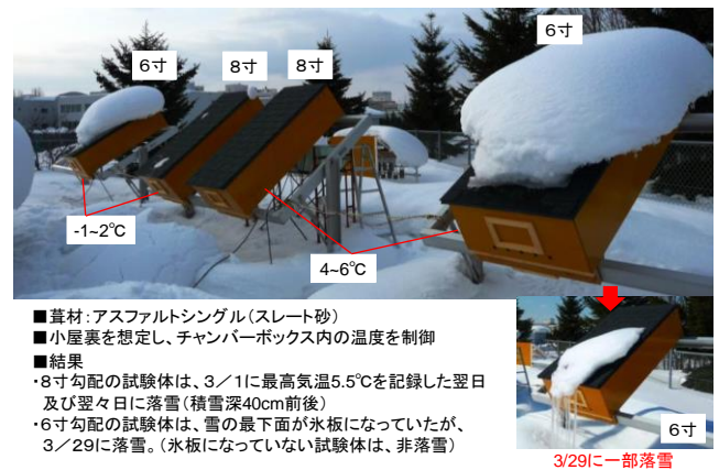
写真1 春先の融雪過程における屋根の積雪状態
