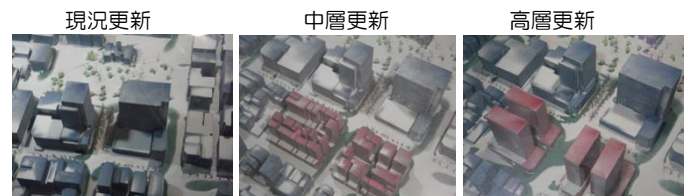
図1 風洞実験による街区形態の比較
