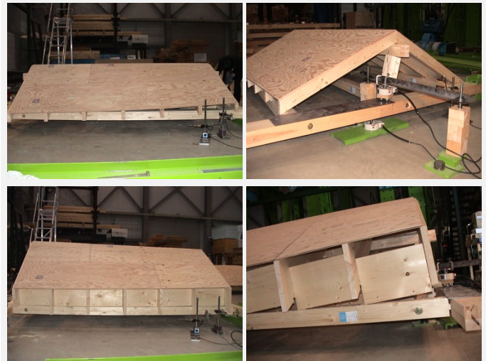
写真1 屋根構面のせん断実験：勾配屋根の破壊性状の確認
