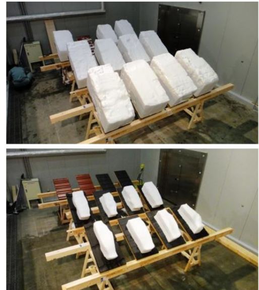
写真1 滑雪試験の様子（手前2列が粗面の屋根葺材）
