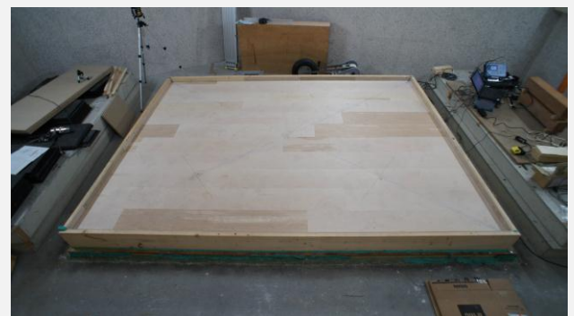
シラカバフローリングの試作品を使用した二重床の測定
