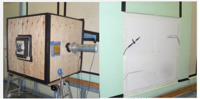
写真2 環境制御室での温湿度、圧力差等の測定
