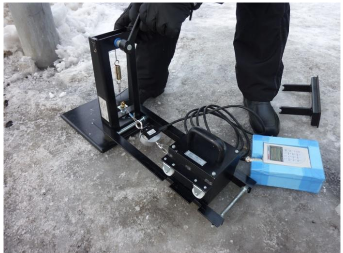
図2 転倒箇所での滑り性の計測
