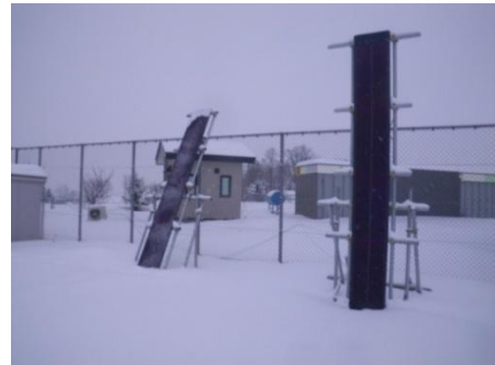
図1 垂直および60度の設置された太陽電池の実測
