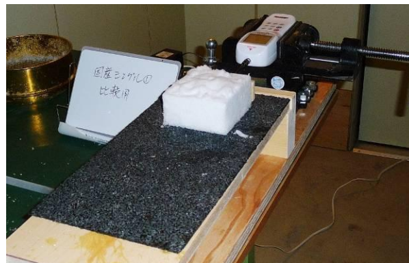
写真3 屋根雪とシングル材との摩擦係数測定
