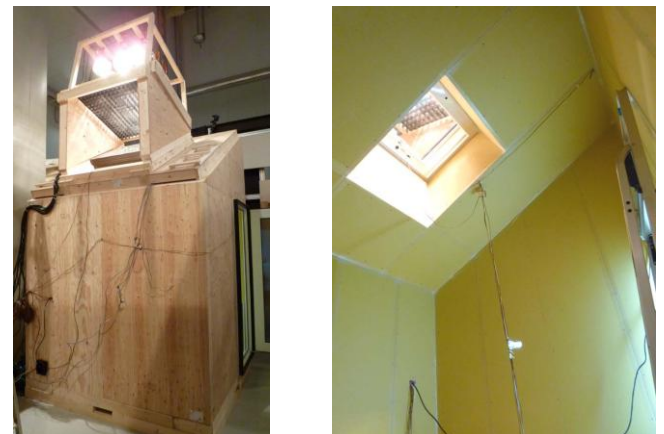
図2 天窗の熱性能の模型実験（準備中）
