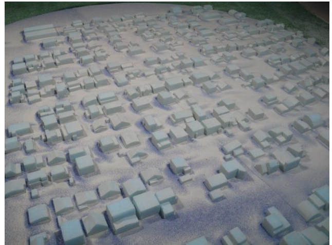
写真1 住宅地内の積雪分布に関する風洞実験の様相
