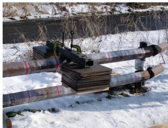
写真2 実物を用いた载荷試験
