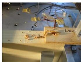
☞構造用合板(9mm規格)の破断
