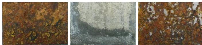
Zn 鋼板(308 サイクル) GL 鋼板(1148 サイクル) SD 鋼板(588 サイクル)
