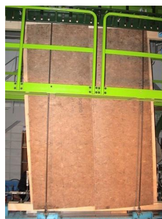
▲実大壁体による構造性能確認実験
