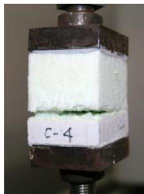
図3 接着強さ試験の様子
