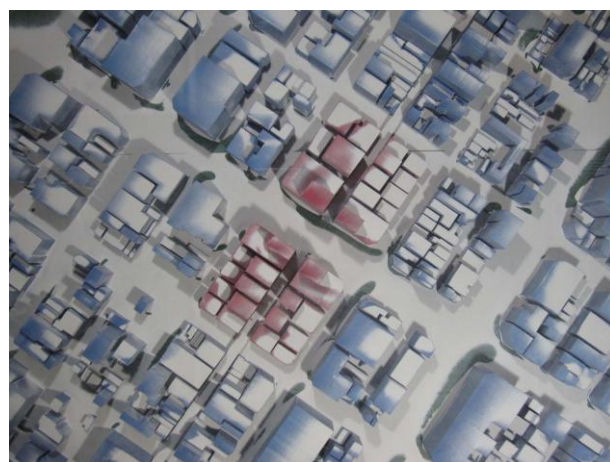
写真 1 風洞実験による積雪シミュレーション
