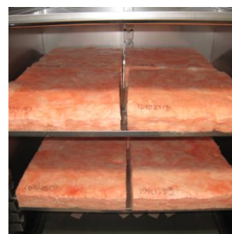
写真3 加速劣化試験状況
