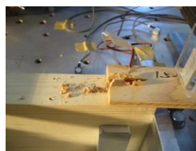
☞ 構造用合板(9mm規格)の破断
