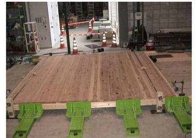
▲厚板を活用した水平構面法の構造性能の検証
