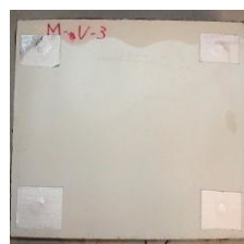
(a) 排水試験体（劣化なし）
