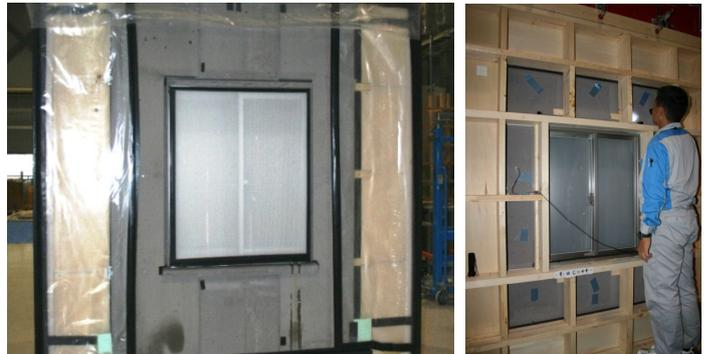
図2 開口部周り部材の水密試験
