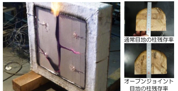
図3 オープンジョイント目地の防火試験
