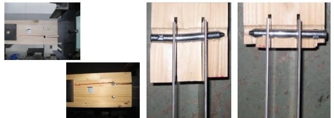
▲ トドマツ鋼板挿入型ドリフトピン接合試験体の破壊形式の確認
