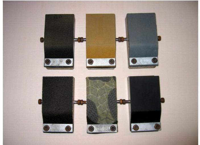
写真1 滑り片の例（靴底、研磨紙）
