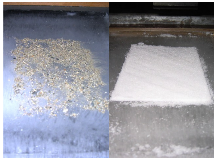
写真2 氷板上の滑り止め砂と雪
