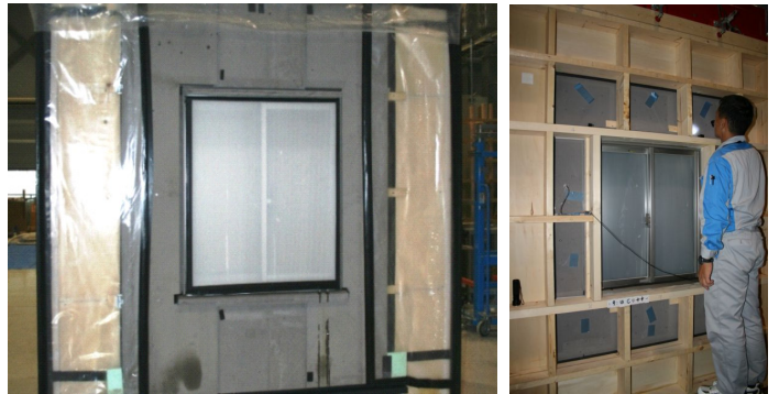
図2 開口部周り部材の水密試験
