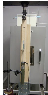
▲外張断熱壁における外装材下地支持力の試験方法の一例
