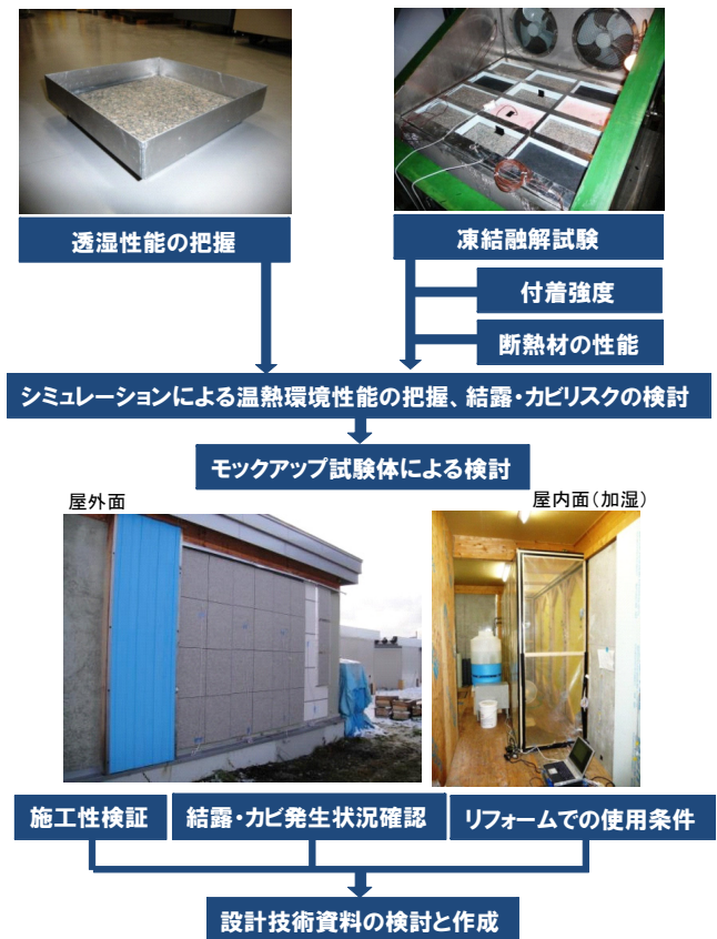
図1：研究の流れおよび実験・モックアップ試験体の様子
