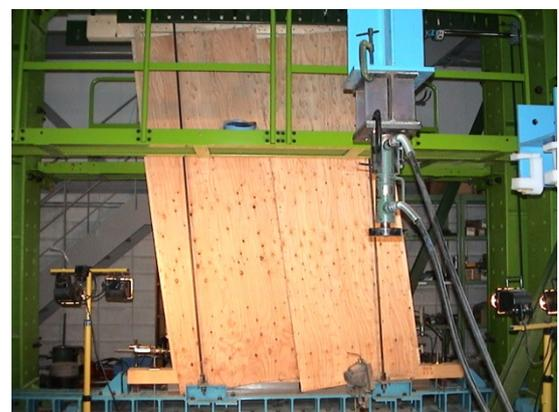
外張り付加断熱耐力壁の加力実験
