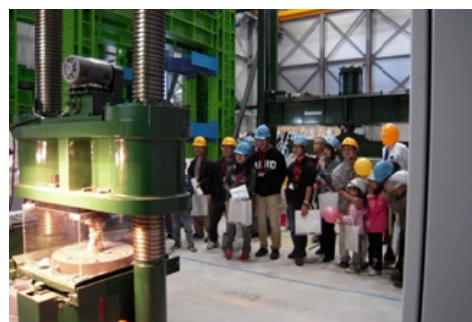
見学ツアーで行われた コンクリート圧縮強度実験
