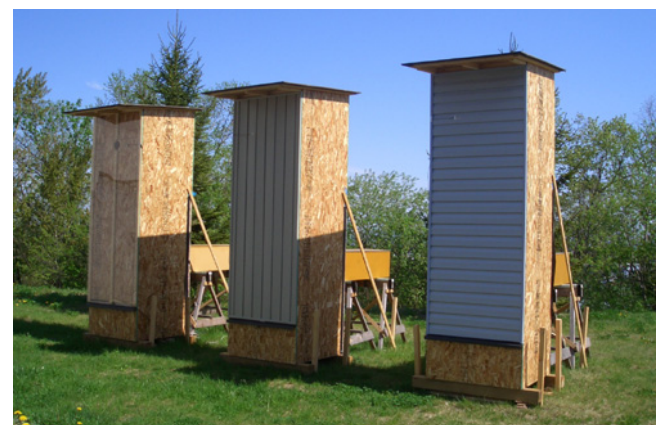
図2 通気層裏面空隙利用給気口の虫侵入実験
