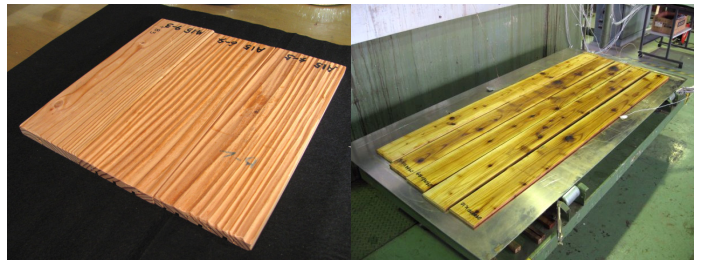
写真2 圧縮木材生産技術を応用した表面加工技術
