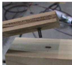
◀加振により破断した釘(N50)
