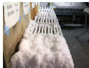
写真1 ルーバ型庇の積雪実験
