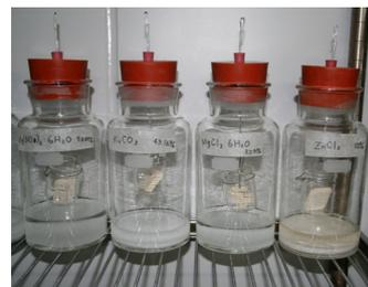
図2 平衡含水率測定の様子
