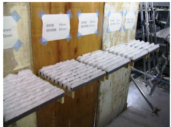
写真1 材幅・ピッチを変えたルーバ庇の積雪実験
