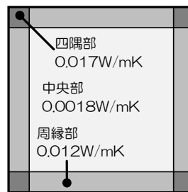
図4 真空断熱材の各部の熱伝導率の例
