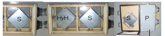
S：現行仕様 HyH+S：室内側の顕熱・潜熱回収率高 H：1個で高効率化 S+P：室内側全熱・屋外側 t-t_{17}
