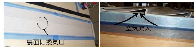
図2 裏面空気層の自然給気利用のための開口面積測定
