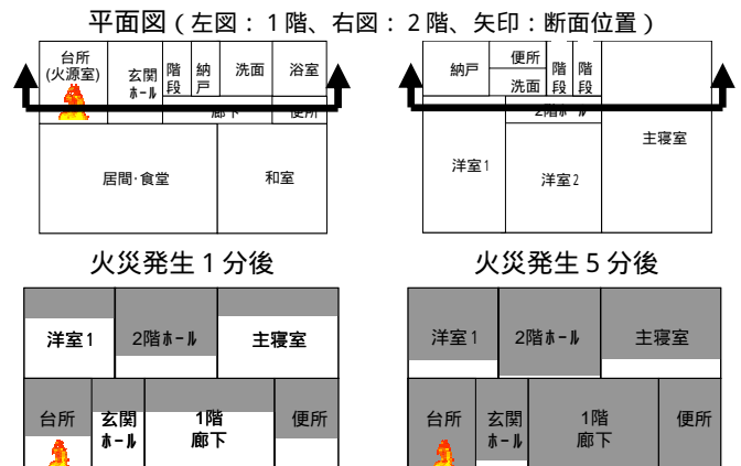
図3 高気密住宅における煙流動性状のモデル検討
