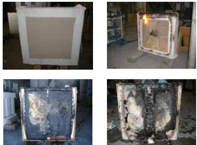
図2 小型加熱炉による防耐火試験
