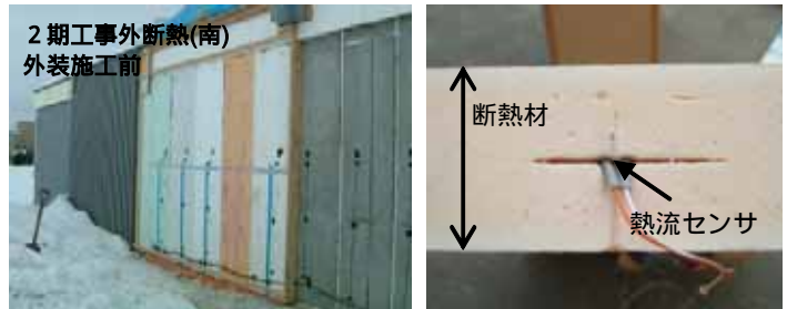
図2 実大実験棟の断熱材
