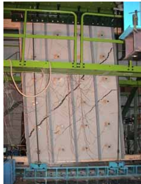
モルタル外装材と躯体との応力伝達の評価実験
