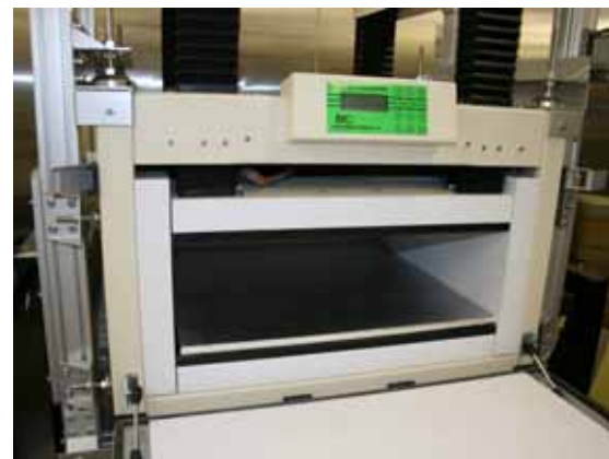
真空断熱材の熱伝導率の実測の様子
