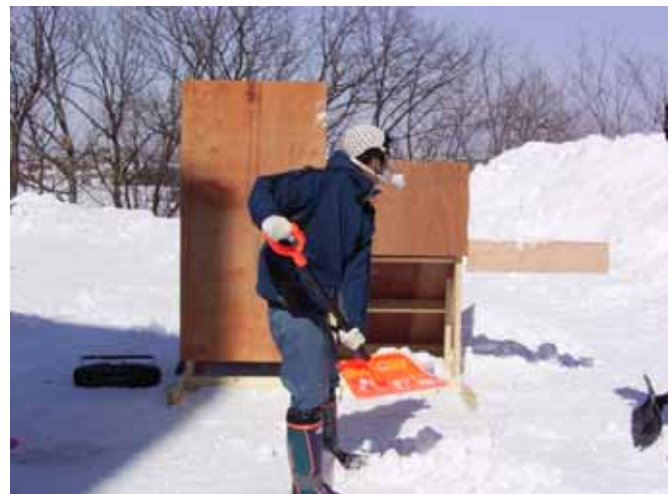
写真 除雪作業負担実験（スコップ使用時）
