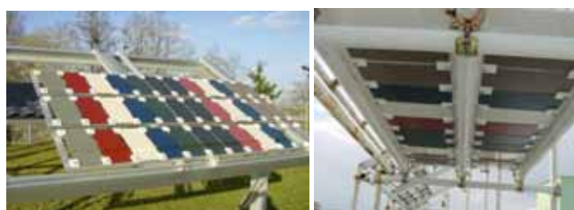
写真 暴露試験状況（左：傾斜暴露、右：下向き暴露）
