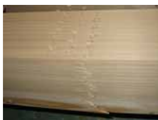
(b)穿孔 6×14箇所 (残存強度 64%)
