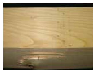
(c)穿孔 3×9箇所 (残存強度 86%)
