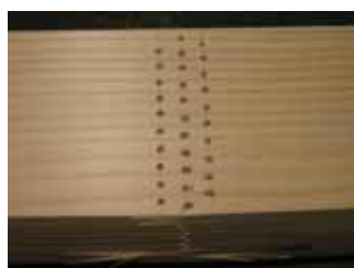
(a)穿孔 3×31箇所 (残存強度 77%)
