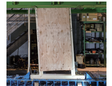
木造耐力壁の加力試験
