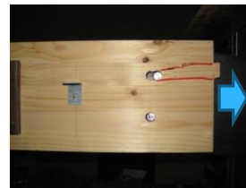
繊維方向の引抜(めり込み)試験
