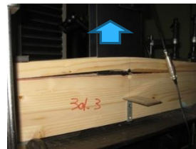
繊維直交方向の引抜(めり込み)試験
