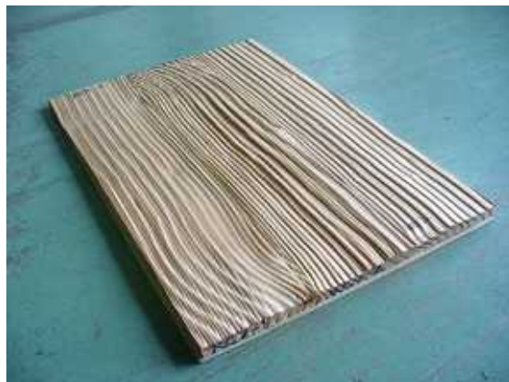
写真 4 - 2 5 同樹種積層圧縮面にできた凹凸
