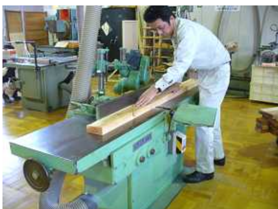
写真 4 - 6 手押し鉋盤による基準面鉋削
