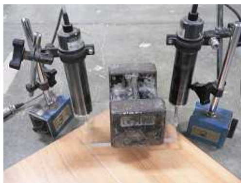
写真 3 - 16 くい込み量の測定状況
