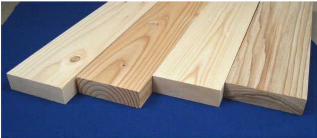
写真2 - 1 北海道産主要針葉樹材（左よりトドマツ，カラマツ，アカエゾマツ，スギ）
