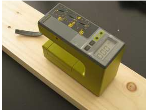
写真 4 - 9 誘電率式含水率計
