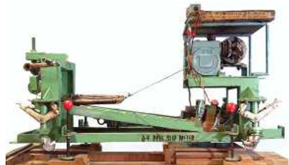
写真 3 - 1 5 引っかかり力の測定状況
