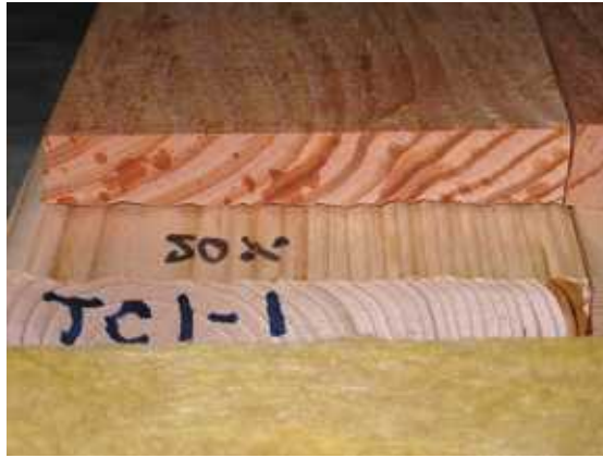
写真 4 - 2 6 異樹種積層による圧縮面
