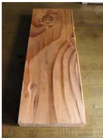
写真4-23 木目の浮き上がった凹凸
