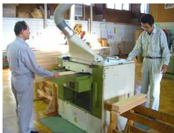
写真 4 - 7 自動鉋盤による厚さ規制
