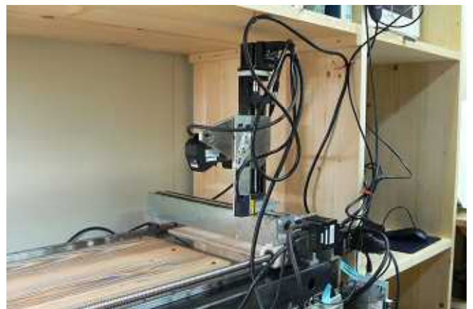
写真 3 - 2 2 表面形状測定装置
