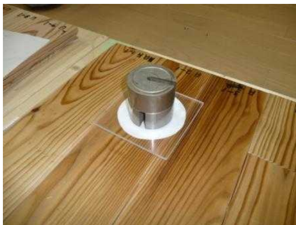
写真 3 - 2 0 吸水速度測定状況
