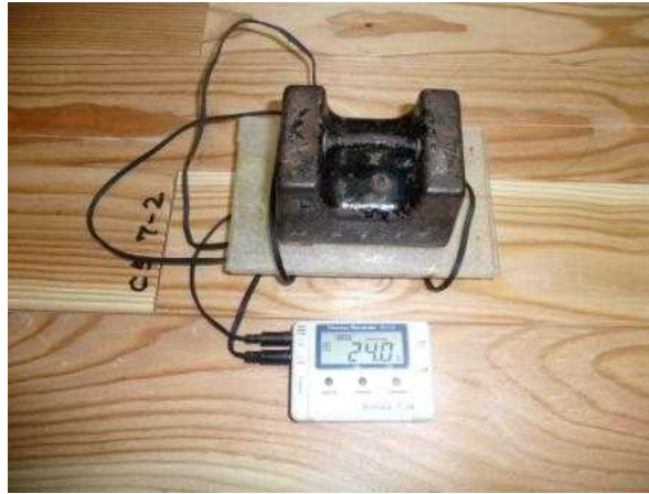
写真 3 - 1 8 温度変化測定装置
