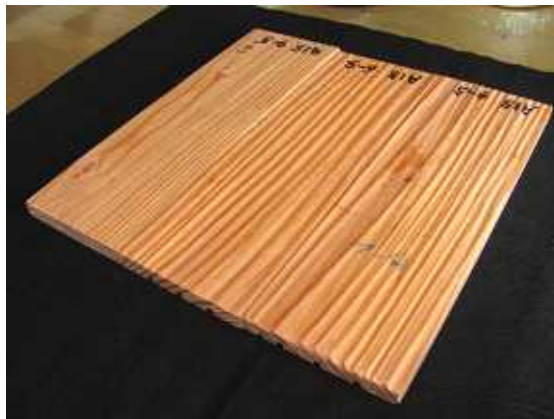
写真 4 - 2 7 異樹種積層圧縮面にできた凹凸
