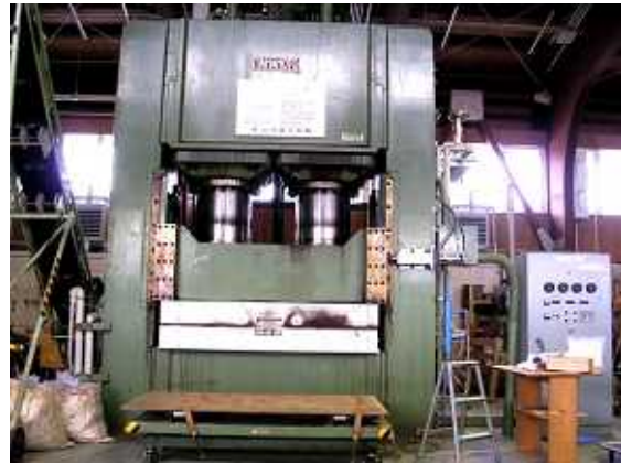
写真 4 - 1 8 実大試作用大型ホットプレス
