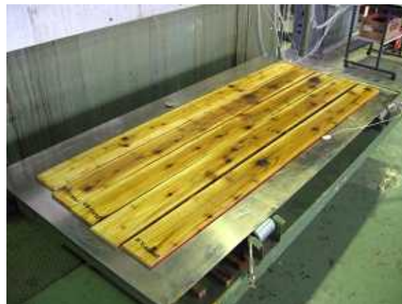
写真 4 - 2 0 カラマツ全層圧密材の試作
