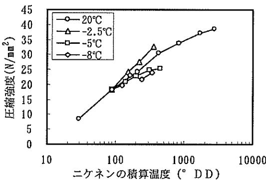
図3.5 凍結したコンクリートの強度とニケネンの積算温度
