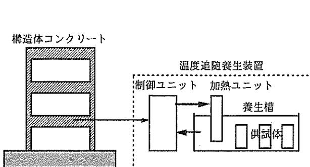
図 3.12 温度追隨養生装置の概念
