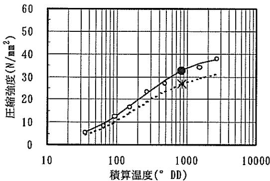
図 3.10 圧縮強度の試験値と標準曲線の例
