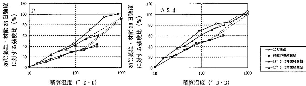
図2.7 凍結環境（-5℃）下で養生されたコンクリートの積算温度と圧縮強度増進の関係
