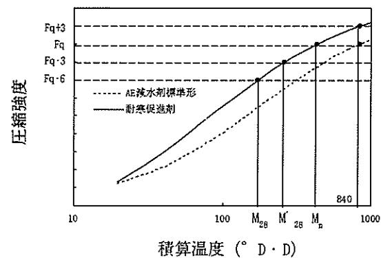
図2.13 強度補正値  $T_n = 3 \text{ N/mm}^2$  の場合の強度増進曲線と材齢28日強度の考え方
