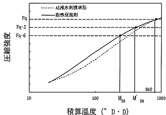
図2.12 強度補正値  $T_n = 0 \text{ N/mm}^2$  の場合の強度増進曲線と材齢28日強度の考え方
