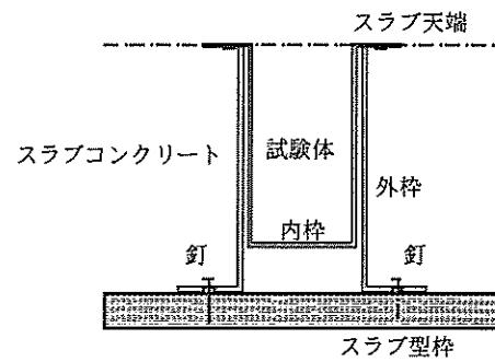
図 3.13 ASTM による打ち込み試験体<sup>8)</sup>
