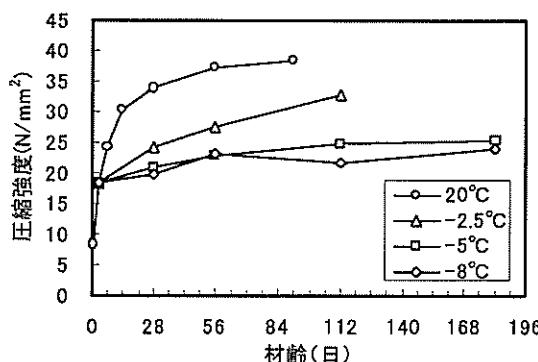
図3.3 凍結したコンクリートの強度増進
