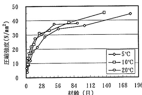
図3.1 強度増進の養生温度による変化
