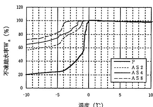
図2.2 コンクリートの温度に対する不凍結水率の変化
