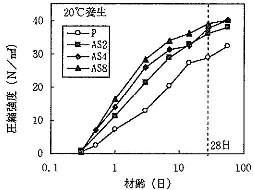
図2.6 20°C養生での材齢と圧縮強度の関係（使用量の影響）
