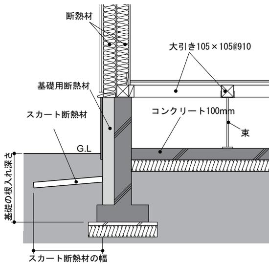
図 3-18 布基礎の場合の寸法の取り方
