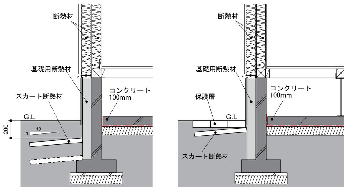
図 3-17 スカート断熱材の位置
