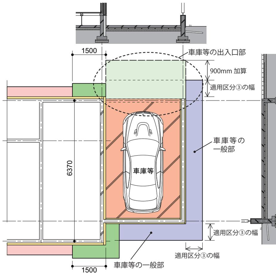
図3-12 車庫等の断熱材適用方法
