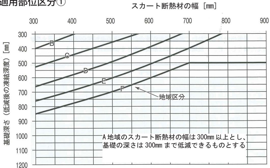
図 3-20 スカート断熱工法を適用した場合の基礎の根入れ深さと断熱材の幅（適用部位区分①）
