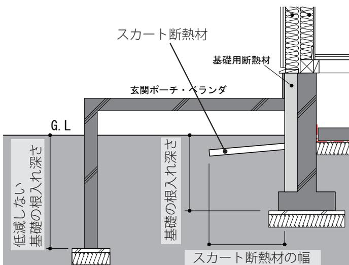
図3-3 スカート断熱工法と通常工法の混在
