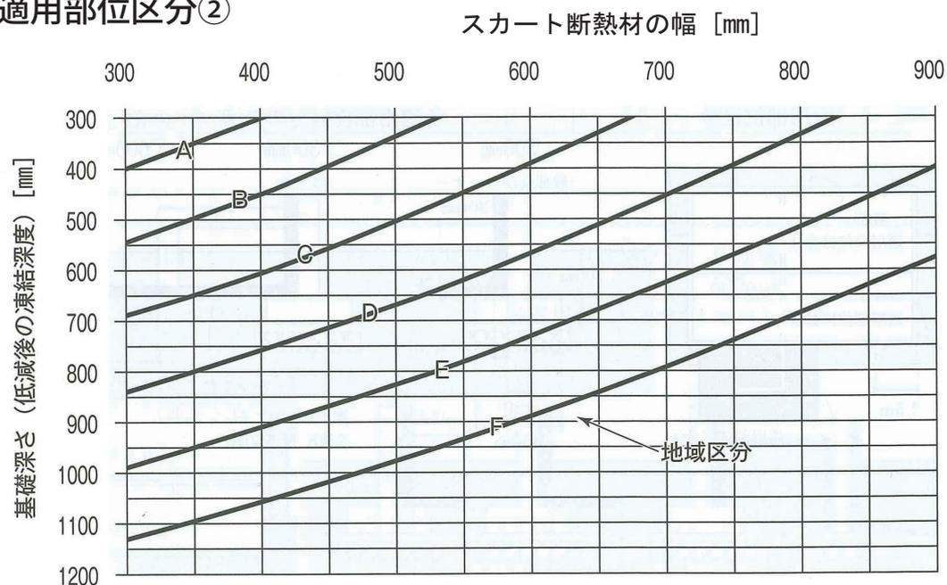
図 3-21 スカート断熱工法を適用した場合の基礎の根入れ深さと断熱材の幅（適用部位区分②）
