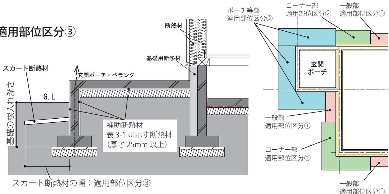
図 3-8 ポーチ等部のスカート断熱材幅
