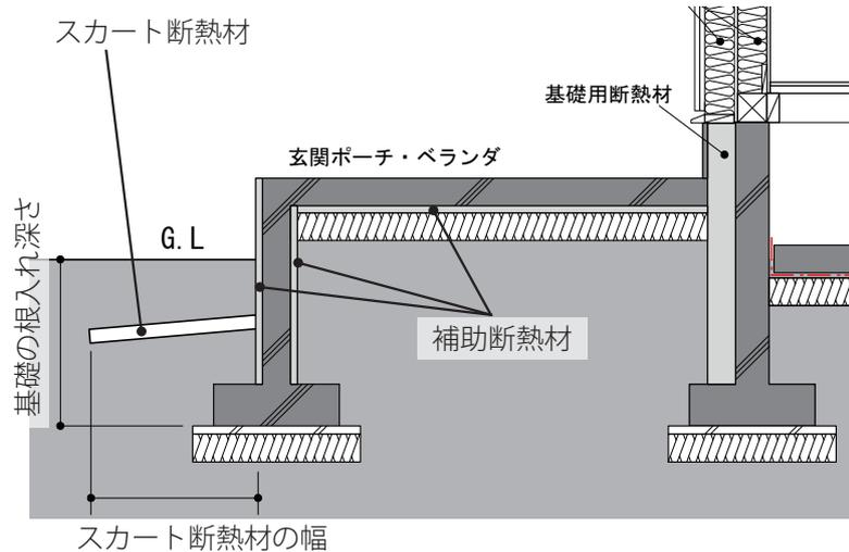
図 3-4 各断熱材の名称と幅、深さの定義
