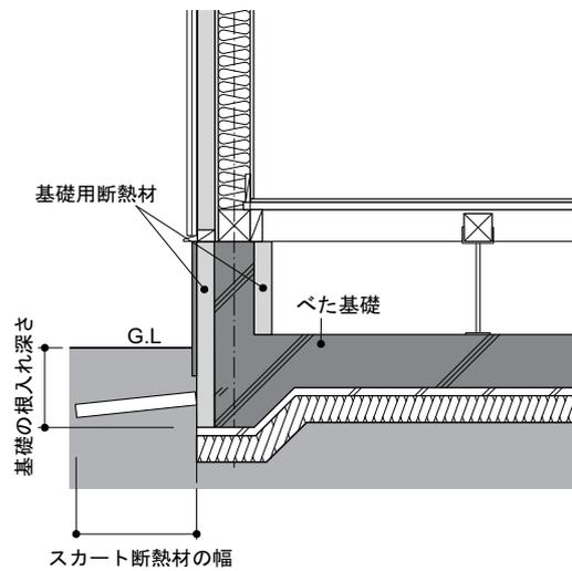
図 3-19 ベタ基礎の場合の寸法の取り方
