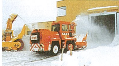
雪冷房用倉庫に雪を入れる様子
