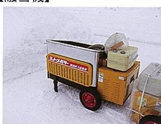
バーナで加熱して短時間で雪を溶
