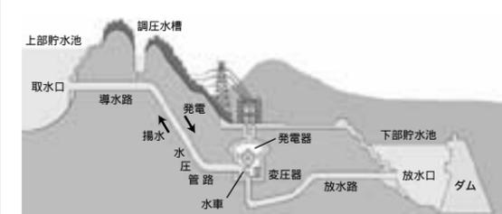
水の落ちる力(位置エネルギー)を利用して、発電機を回転させて電気をつくります。
