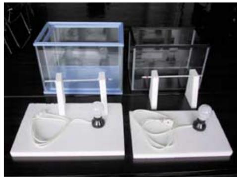
1. 温度計の台になる発泡スチロールに温度計を差し込み、発泡スチロール台のまんなかに電球を置いて水槽をかぶせる。
