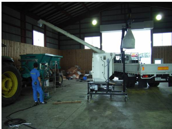
写真1 単肥自動供給装置(中央)
