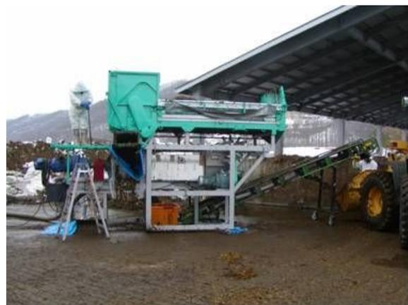
写真1：開発した固液分離システム
