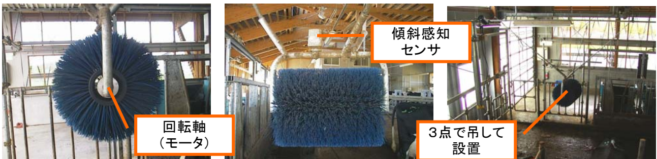
写真1 牛体自動牛ブラシ(左:側面、中央:正面、右:設置状況)
