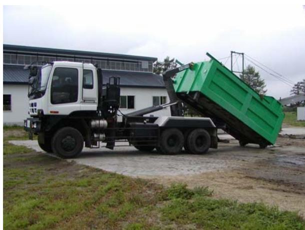
写真2 コンテナを搭載するアームロール車
