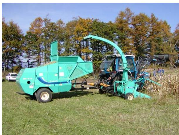
写真1 細断型ロールベアラ
