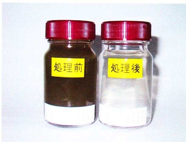
写真 処理前・処理後の汚水
