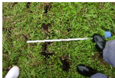
写真24 施工痕、孔深は100mm強
