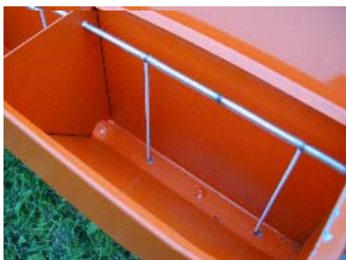
写真23 ホッパ部、種子調節スリット、振動ワイヤ
