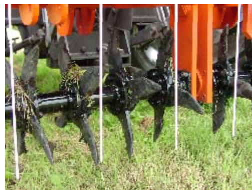
写真22 穿孔作成部と振動ワイヤ
