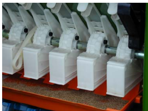
写真7 キャリブレーションと種子回収時の状態
