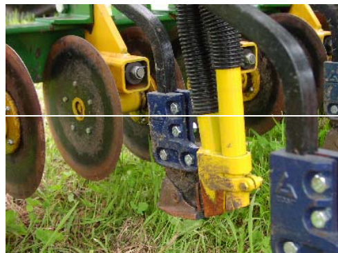
写真10 コルタ(作溝部)、播種部、Tオープナ
