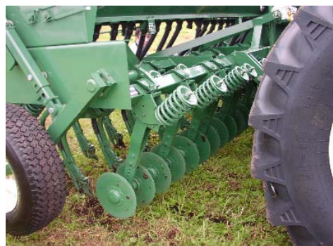
写真14 コルタ(作溝部)とコイルスプリング
