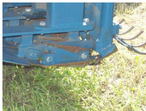
写真6 作溝部、播種部、鎮圧部
