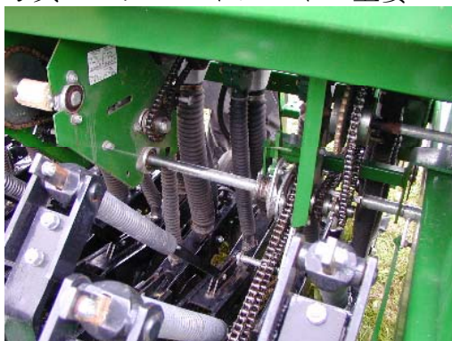
写真19 播種量調整部(ギア、目盛、ハンドル)
